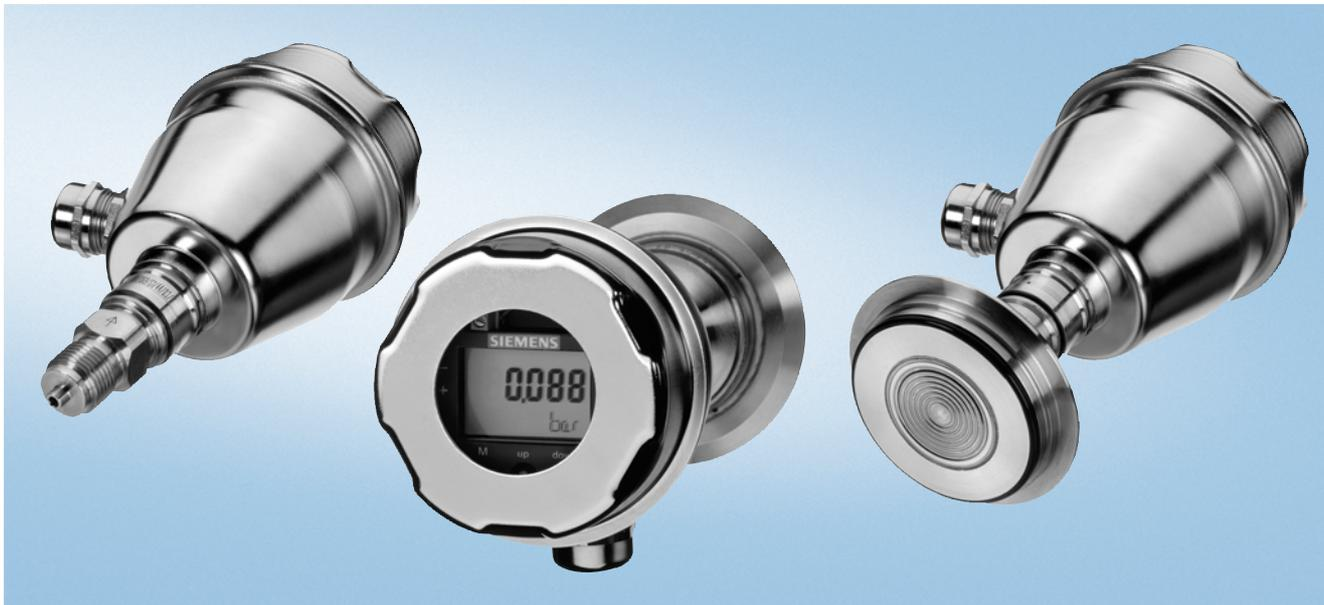
SITRANS P300 是数字式压力变送器，用来测量表压和绝压。所有的常规螺纹型号都可用于过程连接。另外，各种卫生型连接和带有膜片冲洗的法兰连接都符合无死区过程连接的要求。
