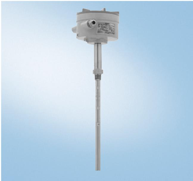
Pointek CLS500 是检测界面、固体、液体、浆料和粘稠介质物位的反相频移电容物位计，它可以工作在过程温度高达 400 °C 和压力高达 525bar 的苛刻工艺条件下。
