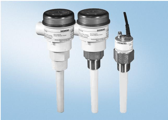
Pointek CLS 100 是紧凑的二线制反相频移电容开关，适于在空间有限的场合内检测界面、液体、浆料和泡沫等。
